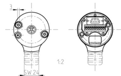
Empfohlene Gewindelaenge der Kabelverschraubung: 14mm
