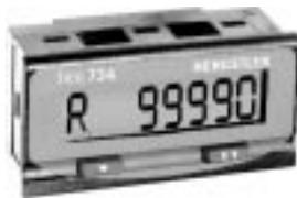
Dieses Gerät kann Durchfluß oder Drehzahl anzeigen und gleichzeitig die Menge oder Länge aufsummieren. Der 4-stellige Tachometer garantiert durch die Pulsbreitenmeßmethode (1/Tau) genaue Meßergebnisse. Der 8-stellige Summenzähler erfaßt gleichzeitig die eingehenden Impulse. Separate Skalierfaktoren für Tacho und Summenzähler ermöglichen die Anzeige in aussagekräftigen Einheiten.
